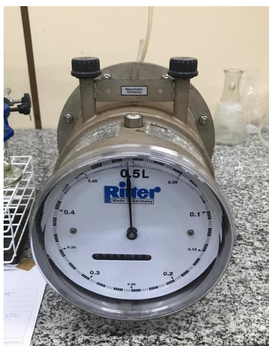
Figura 17 - Medidor volumétrico de biogás Ritter
