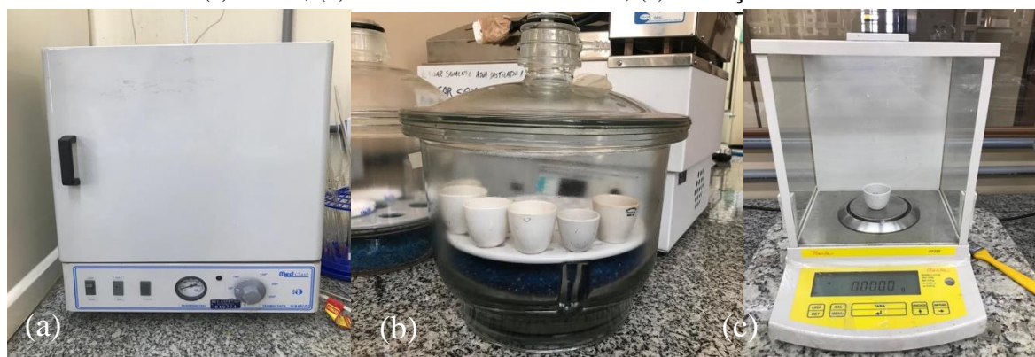
Figura 8 - Instrumentos usados para a análise do teor de MS (a) Estufa; (b) Dessecador com cadinhos; (c) Balança analítica
